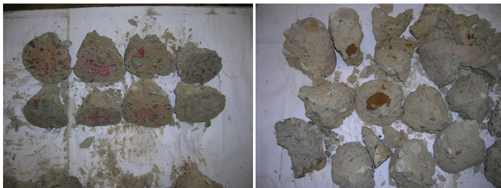
Rysunek 3. Widok na próbki starego betonu po badaniach wytrzymałościowych
