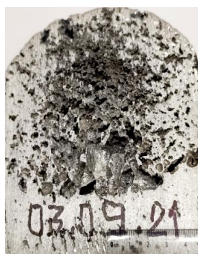
Фиг. 3. Пореста отливка от Al
