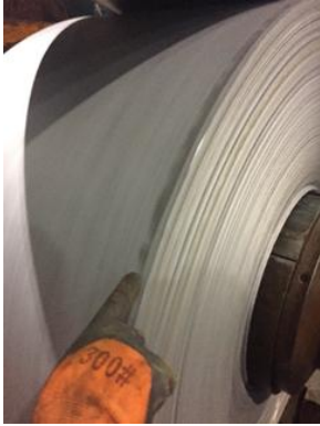
Фиг. 5 Байцван горещо валцуван рулон с недотрав (окис по повърхността на рулона)
