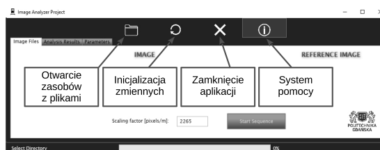
Rys. 8. Graficzny interfejs użytkownika aplikacji desktopowej – „Image Analyzer Project”
