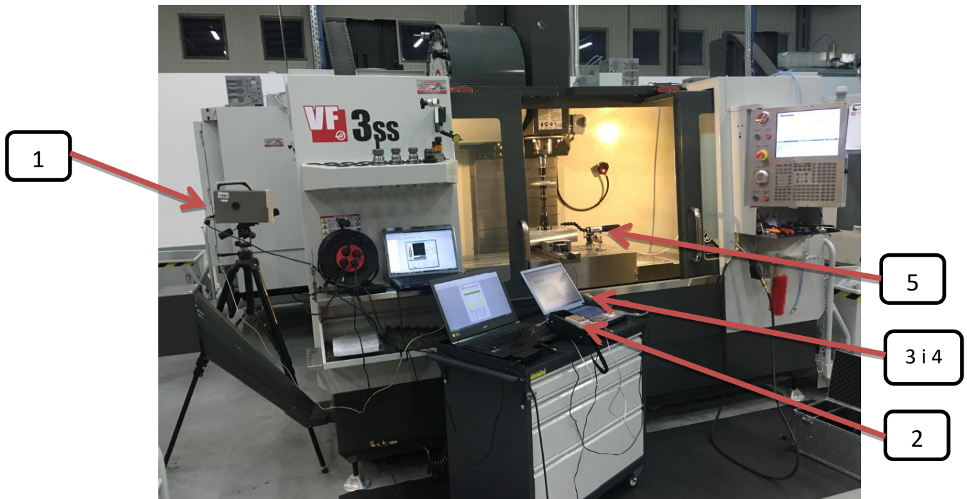
Rys. 155. Frezarka Haas VF-3SS z oprzyrządowaniem do gładzenia: 1) kamera termowizyjna, 2) chropowatościomierz Mitutoyo SJ-210, 3) miernik natężenia dźwięku, 4) mierniki drgań, 5) dysza powietrzna, średnicówka mikrometryczna (nie pokazana na zdjęciu)
