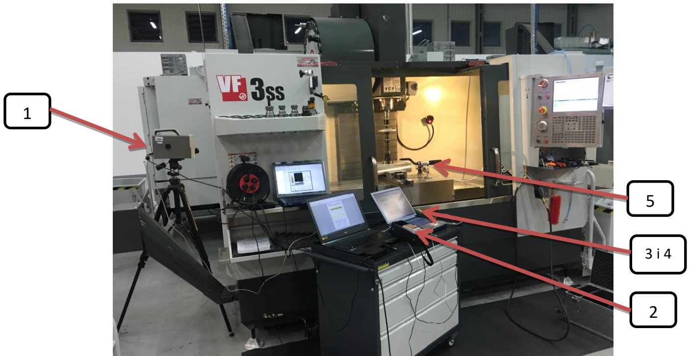
Rys. 155. Frezarka Haas VF-3SS z oprzyrządowaniem do gładzenia: 1) kamera termowizyjna, 2) chropowatościomierz Mitutoyo SJ-210, 3) miernik natężenia dźwięku, 4) miernikiem drgań, 5) dysza powietrzna, średnicówka mikrometryczna (nie pokazana na zdjęciu)
