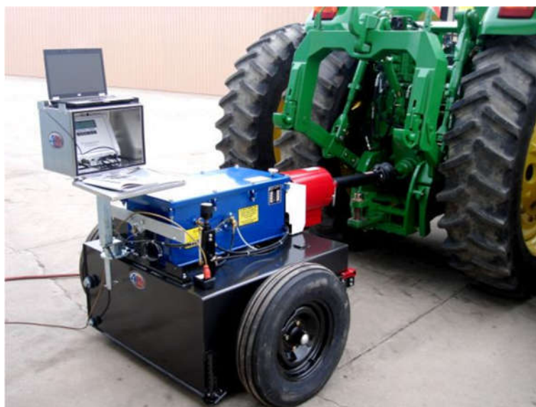
Rys. A.7. Przenośna hamownia WOM podczas obciążania silnika w ciągniku rolniczym [152].
