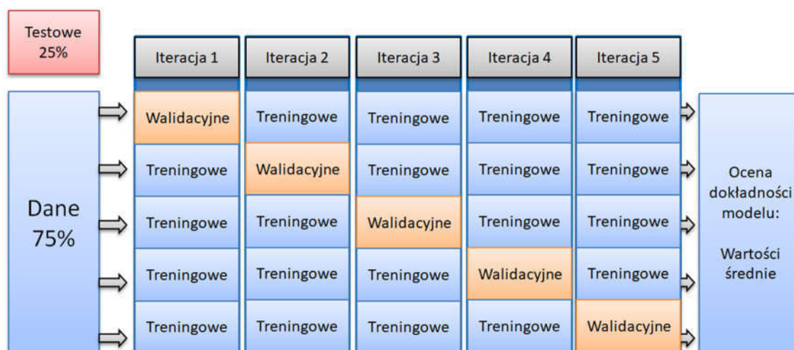
Rys. 7.2. Walidacja krzyżowa 5-krotna. Losowy podział obserwacji na 5 podzbiorów. W każdej iteracji inny podzbiór jest traktowany jako dane walidacyjne. Wynikiem jest wartością uśrednioną ze wszystkich iteracji.
