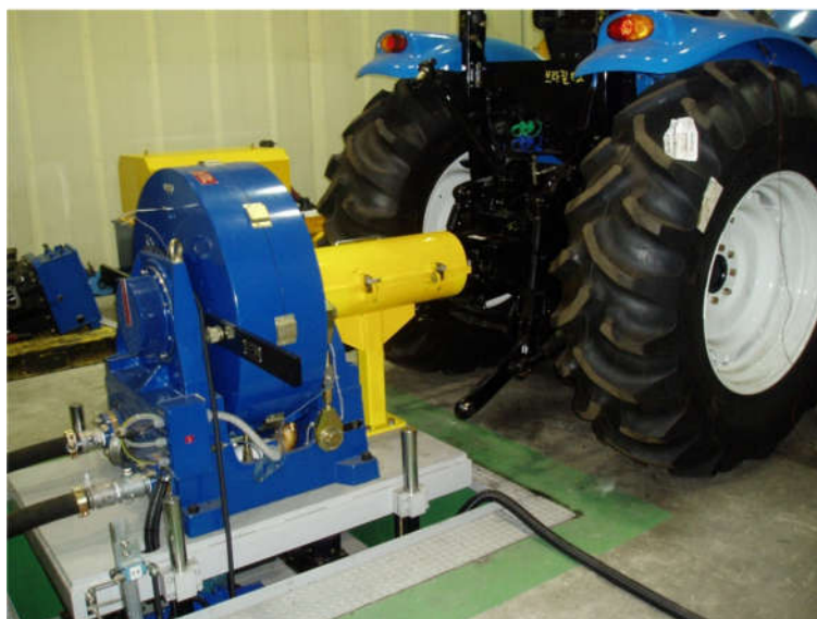
Rys. A.6. Stacjonarna hamownia WOM [151].
