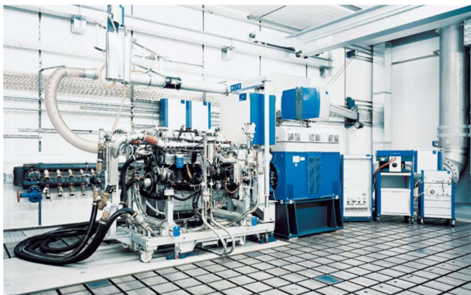
Rys. A.1. Hamownia silnikowa firmy AVL [137].
