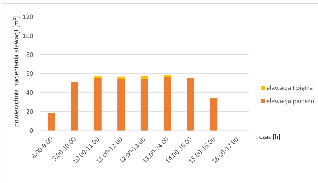
Rysunek 56. Powierzchnia parteru oraz I piętra elewacji południowej zacienniona przez szpaler 20-25-letnich klonów jawor zlokalizowanych w ulicy o kierunku wschód–zachód i parametrze H/W równym 0,6 w odległości 3 m od zabudowy w dniu 7 czerwca w godzinach 8.00–17.00 w wybranej lokalizacji
