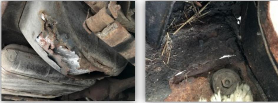
Rys. C.10. Korozja podłogi – usterka nr 7.3 (NADWOZIE / Podłoga)
