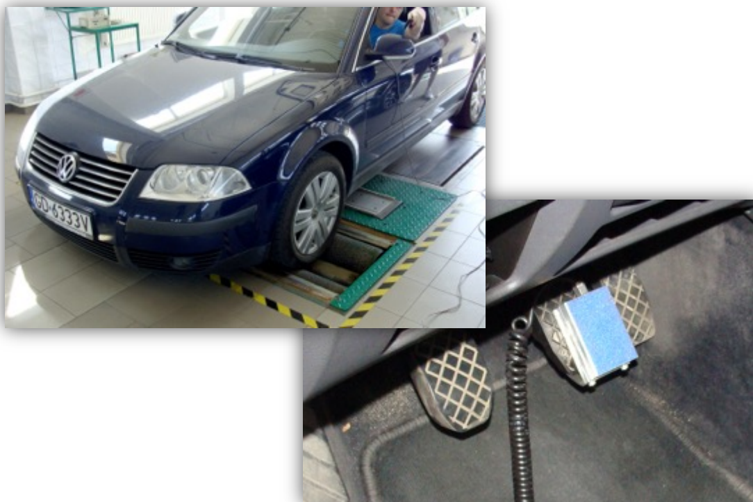
Rys. 6.6. Pomiar na stanowisku rolkowym do badania hamulców firmy Cartec BDE 4004P-O/M z zamontowanym urządzeniem do pomiaru nacisku siły na pedał hamulca
