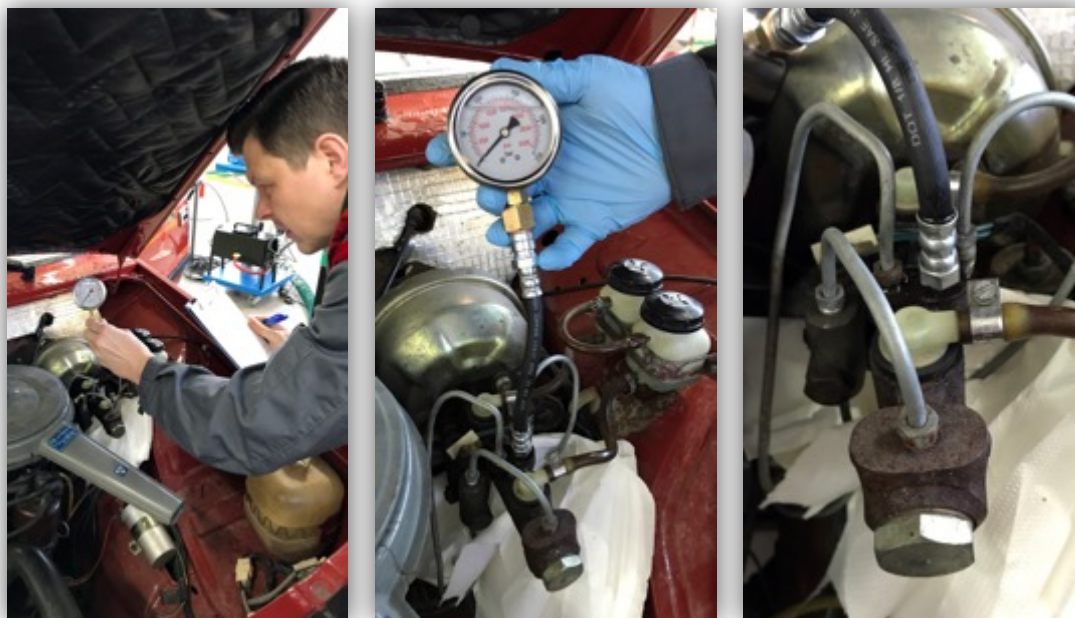
Rys. 8.9. Pomiar ciśnienia w układzie hamulcowym w pojeździe marki FSO Polonez z 1981 roku
