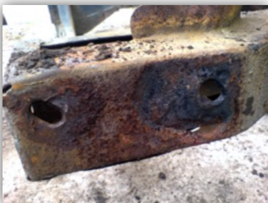
Rys. 2.16. Skorodowana rama pojazdu - Chrysler 300 z 1969 roku: a) miejsce styku z nadwoziem pojazdu, b) tylna część ramy
