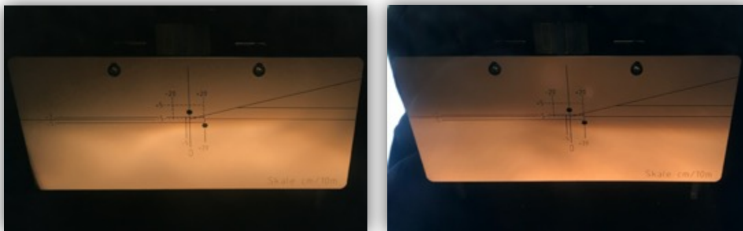
Rys. C.4. Kontrola ustawienia świateł mijania wraz z przykładem uwzględniającym światła mijania badanego Citroena 11 BL z 1956 roku
