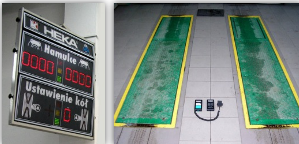
Rys. 6.7. Urządzenie płytowe firmy HEKA do badania hamulców
