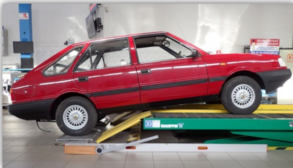
Rys. 8.14. Pomiar nacisku osi tylnej dla pojazdu FSO Polonez na równi pochyłej
