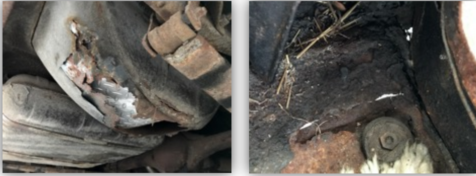
Rys. C.10. Korozja podłogi – usterka nr 7.3 (NADWOZIE / Podłoga)
