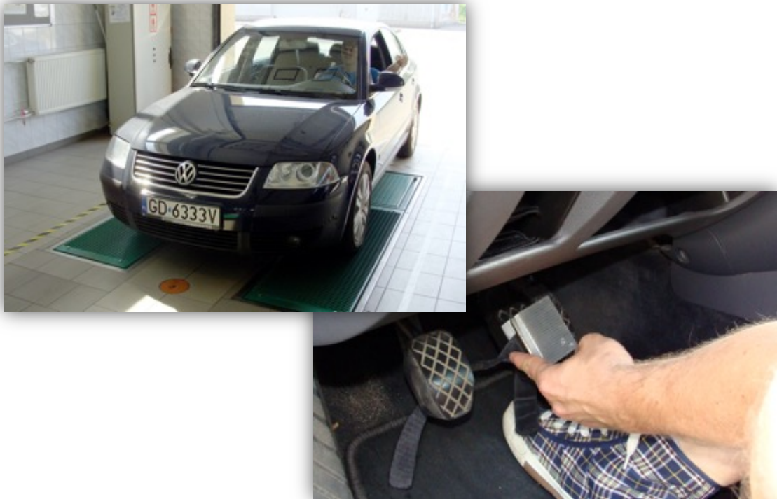
Rys. 6.8. Pomiar na stanowisku płytowym do badania hamulców firmy HEKA z zamontowanym urządzenie do pomiaru nacisku na pedał hamulca
