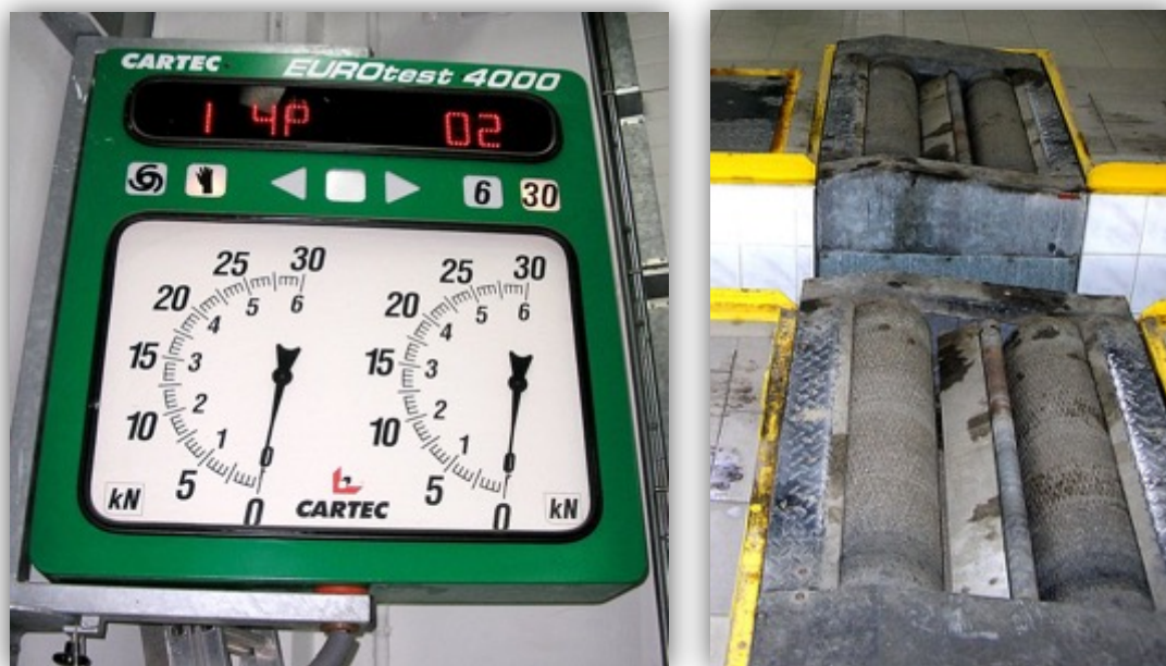
Rys. 6.5. Stanowisko rolkowe do badania hamulców firmy Cartec BDE 4004P-O/M
