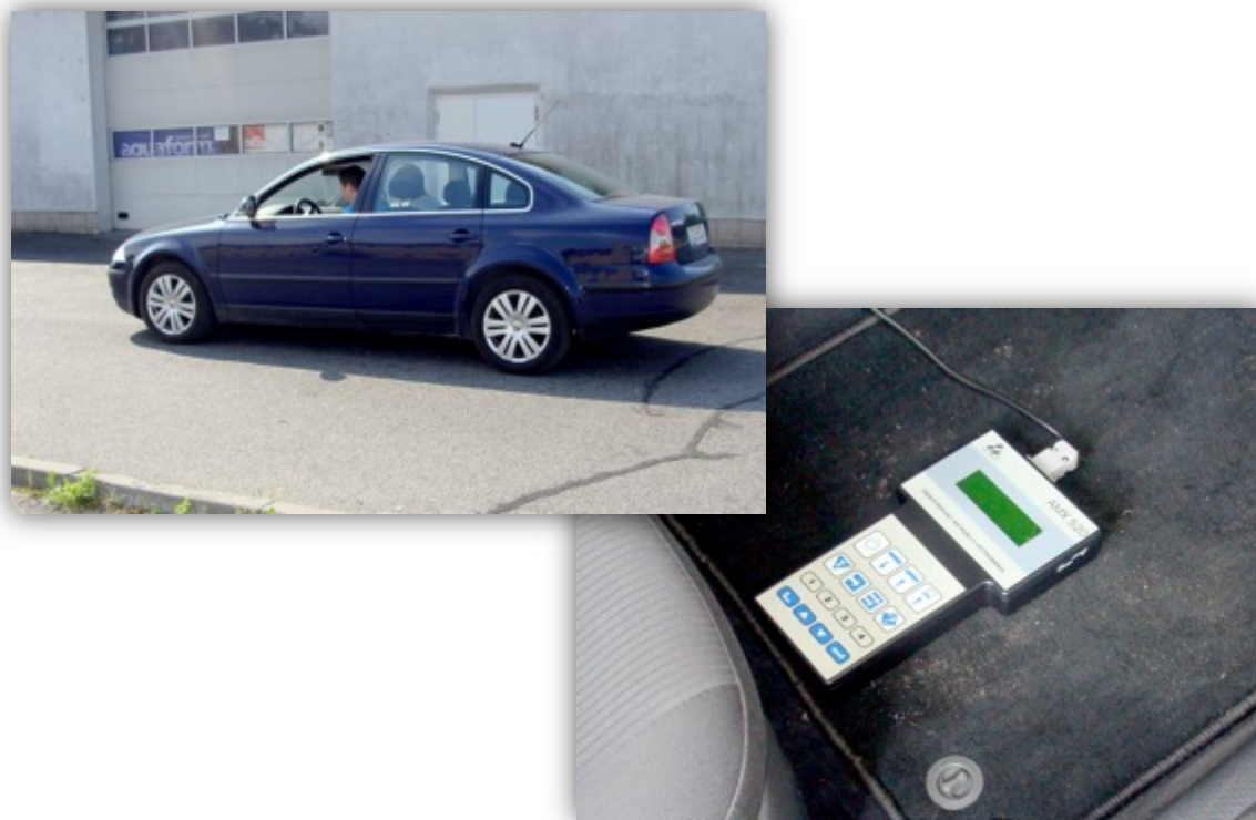
Rys. 6.9. Pomiar opóźnienia za pomocą urządzenia AMX 520 firmy Automex na drodze podczas hamowania
