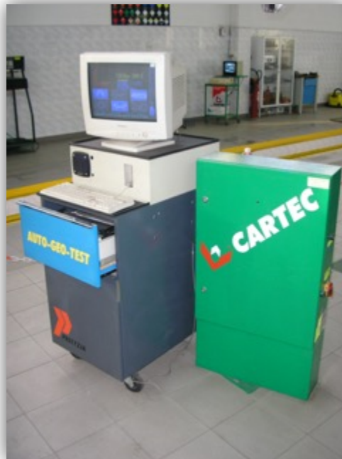
Rys. 6.11. Stanowisko do pomiaru tłumienia zawieszenia – Cartec SSP 2000: a) płyty pomiarowe, b) jednostka centralna
