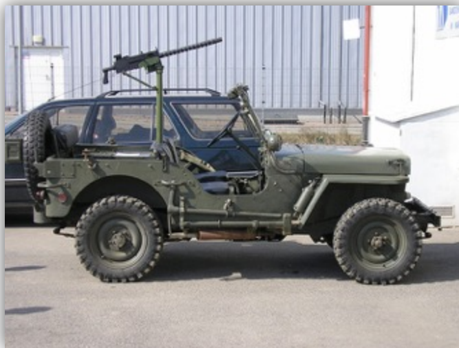
Rys. 2.20. Pojazd militarny z niekompletnym oświetleniem zewnętrznym
