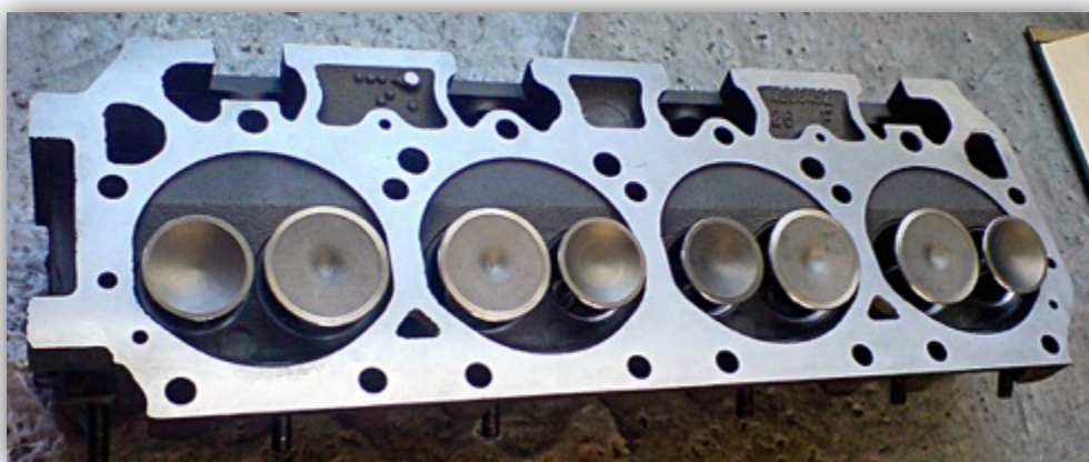
Rys. 2.13. Głowica, zawory po renowacji – Chrysler 300 z 1969 roku
