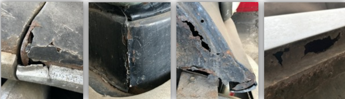
Rys. C.9. Korozja nadwozia – usterka nr 7.1 (NADWOZIE / Stan ogólny nadwozia i kabiny)
