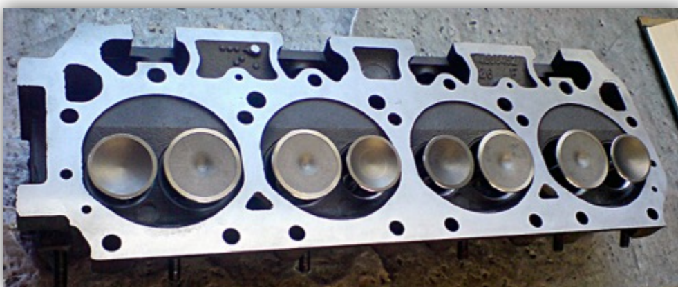
Rys. 2.13. Głowica, zawory po renowacji – Chrysler 300 z 1969 roku
