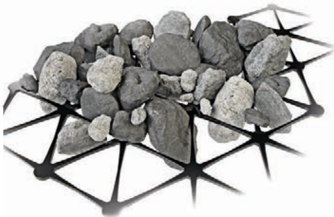
Rys. 1. Klinowanie ziaren kruszywa w georuszcie o równomiernej sztywności radialnej
