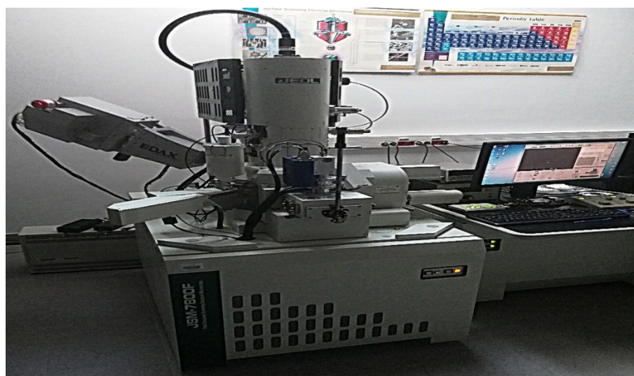
Rys. 5.24. Mikroskop skaningowy JOEL JSM-7800F [103]
