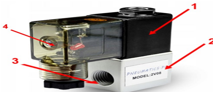
Rys. 5.12. Zawór elektromagnetyczny 2/2 drożny bezpośredniego działania - MODEL:2V08-1/4, (1 - cewka elektrozaworu, 2 - aluminiowy korpus, 3 - podejście gwintowe 1/4", 4 - podejście elektryczne 230V) [100]
