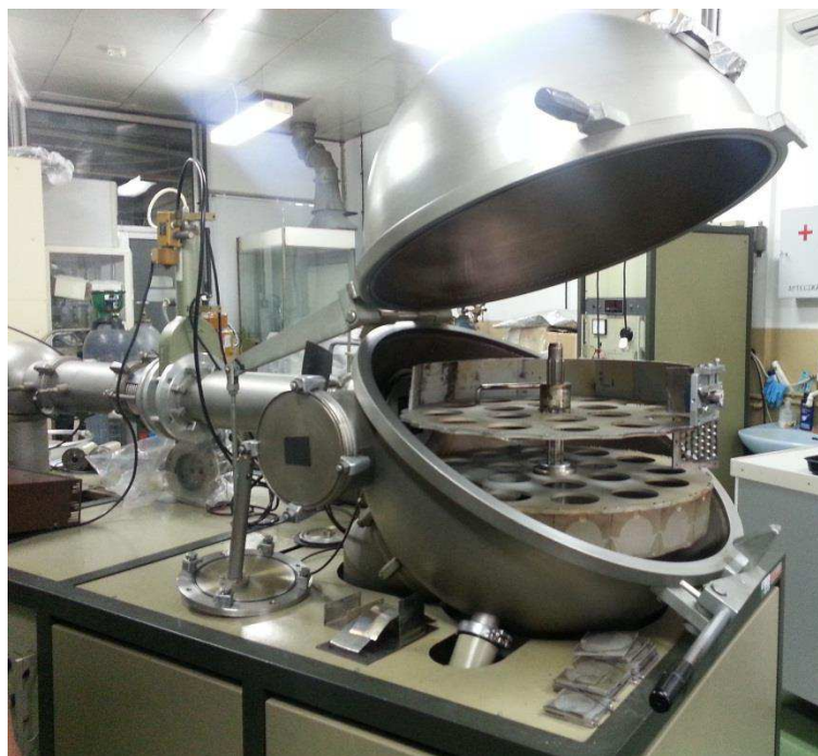
Rys. 38. Widok komory implantatora Balzers typu MPB 202 RP
