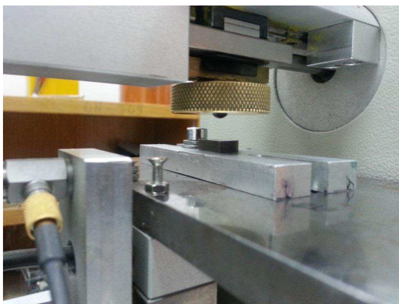
Rys. 46. Widok głowicy badawczej tribotestera Ducom TR-28M (ITME)
