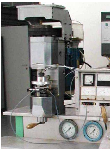
Rys. 48. Widok ogólny tribometru PT-3 [230]
