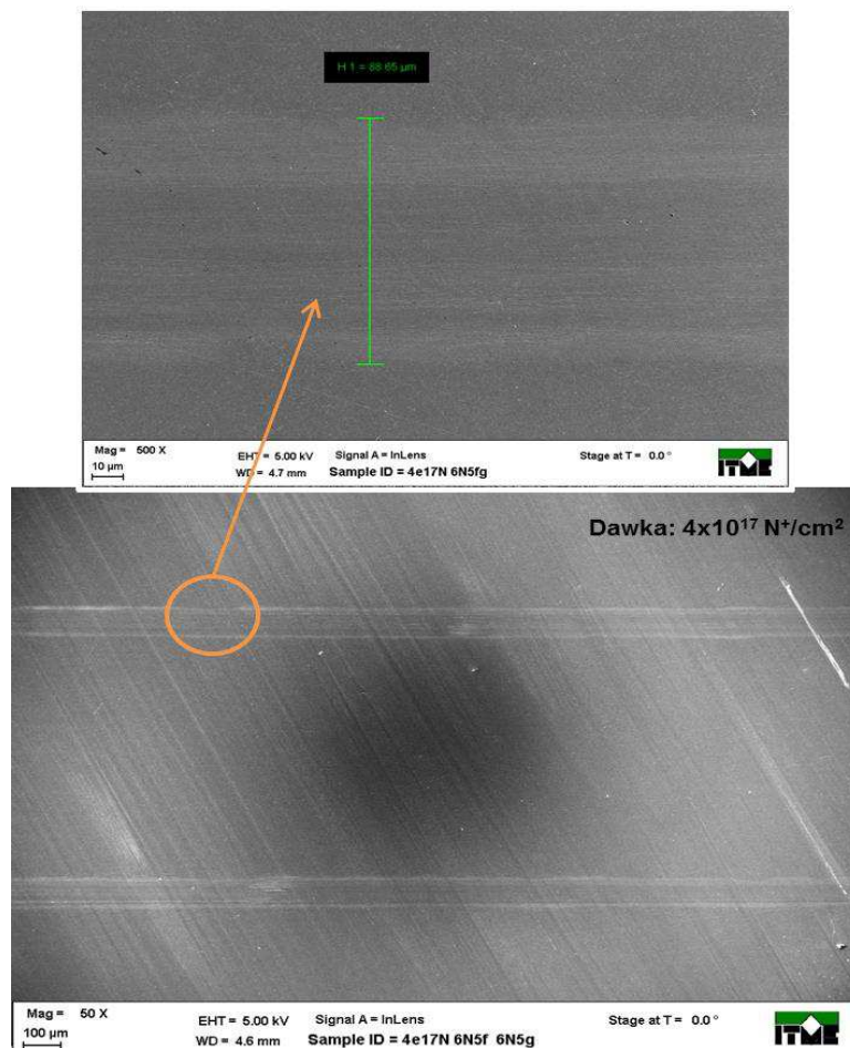
Rys. 95. (SEM) Widok śladów tarcia na powierzchni próbki ze stopu Ti-13Nb-13Zr ( 4 \times 10^{17} \text{ N}^+/\text{cm}^2 ) po testach tribologicznych, pow.: 50x
