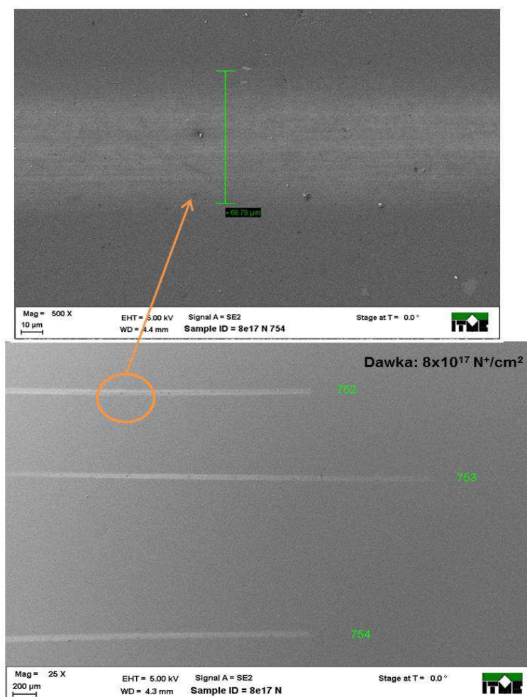
Rys. 96. (SEM) Widok śladów tarcia na powierzchni próbki ze stopu Ti-13Nb-13Zr ( 8 \times 10^{17} \text{ N}^+/\text{cm}^2 ) po testach tribologicznych, pow.: 25x
