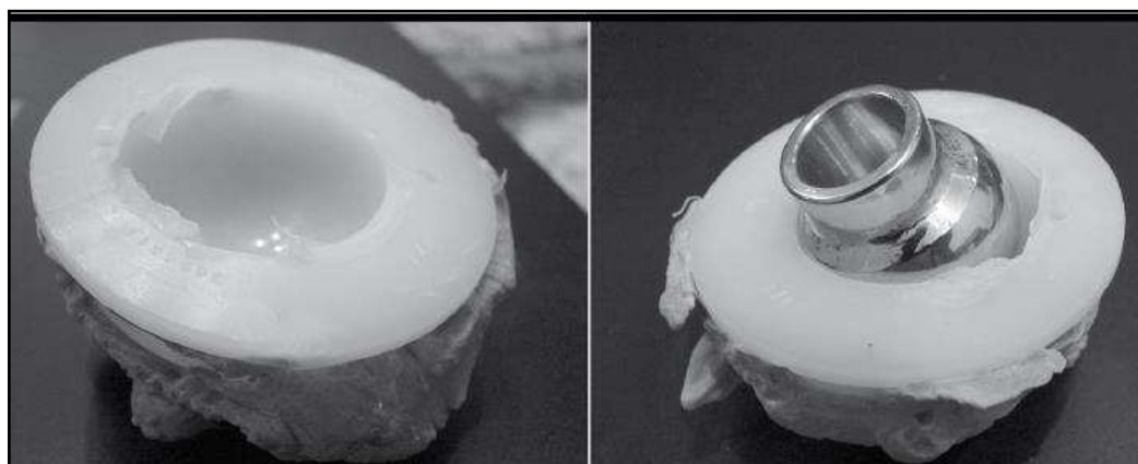
Rys. 16. Panewka wykonana z PE-UHMW z fragmentami cementu kostnego po 10 latach eksploatacji w organizmie ludzkim z widocznymi efektami zużycia tribologicznego, odkształcenia plastycznego i pęknięcia [38]
