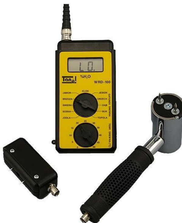
Rys. 7.3. Wilgotnościomierz WRD - 100 z elektrodą młotkową i ręczną ( https://www.merserwis.pl/images/stories/virtuemart/product/tanel-wrd-100-hq.jpg )
