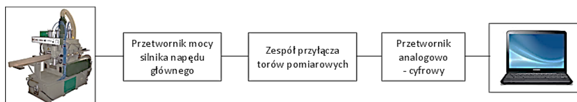
Rys. 7.12. Schemat blokowy stanowiska badawczego (opracowanie własne)
