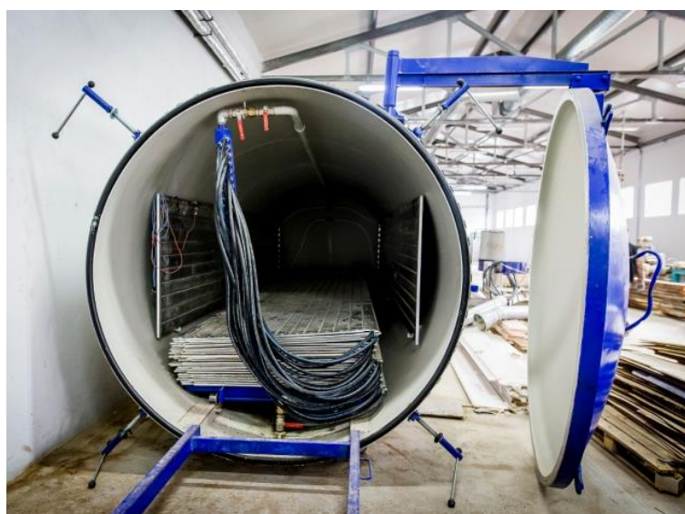
Rys. 7.7. Suszarnia Elvac SP - 10 w PHU DREW - MET: a) widok ogólny; b) widok od strony załadunku z podłączonymi panelami grzewczymi (a) http://elvac.pl/public/media/kociol.jpg ; b) http://elvac.pl/public/media/Radom3.jpg )
