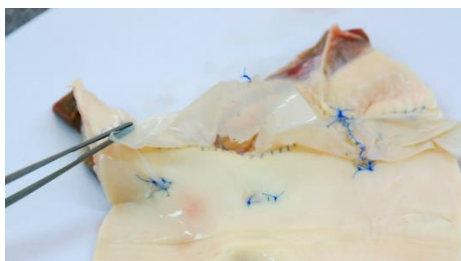
Rys. 4.3. Proteza konstrukcji HAB wykonana z BNC po próbie badawczej [91]
