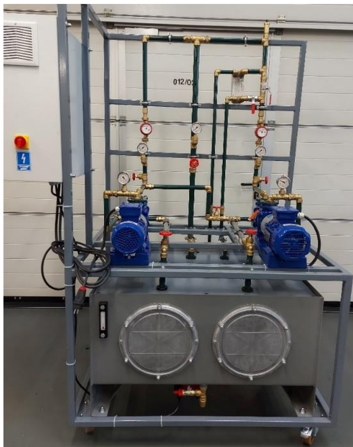
Rys. 3. Widok ogólny stanowiska laboratoryjnego do badania pomp wirowych
