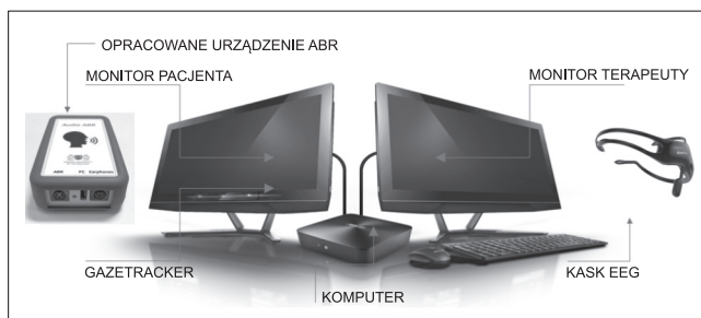
■ Rys 6. Zestaw CyberOko rozszerzony o opracowane urządzenie analizy odpowiedzi z pnia mózgu (ABR), w którym jako pobudzenie stosuje się sylaby
