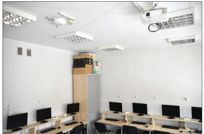
■ Rys. 5. Środowisko testowania prototypu stacji bazowej pracującej ze zintegrowaną anteną ESPAR w systemie BLE. Na ścianie widoczne są moduły referencyjne BLE, które zastosowano w nadmiarowej liczbie w celu przeprowadzenia badań umożliwiających określenie ich optymalnej ilości i pozycji
