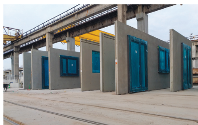
Fot. 2. Proces montażu stolarki okiennej w zakładach prefabrykacji
