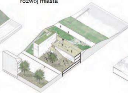
Ryc. 175 Konceptcje zabezpieczeń przeciwpowodziowych wypracowanych w ramach projektu Deichpark Elbinsel (źródło: Report IBA Hamburg, "Hamburg's urban coast – challenges for urban development and flood control")
