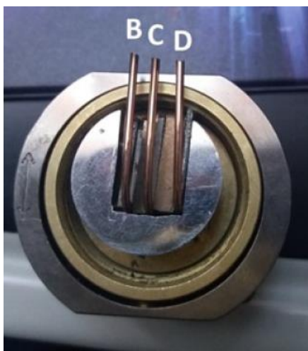
Rys. 2.1. Próbkę drutów w stanie dostawy zamocowane na podkładce do badania mikroskopowego SEM.
