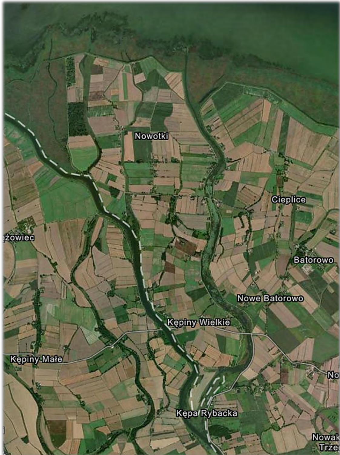
Ryc. 1.12 Ujście rzeki Nogat w dorzeczu Wisły jest ujściem typu deltowego. Liczne kępy obszaru zostały spolderyzowane, dzięki czemu powstał unikatowy system delty Nogatu. Wyspowy polder Nowotki posiada po obwodzie wał okrężny chroniący obszar przed powodzią, Źródło: https://www.arcgis.com/apps/mapviewer/index.html , 2021.
