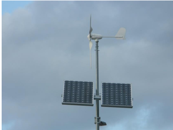
Fig. 8. Hybrid lamp in Kowalewo Pomorskie (photo: B. Igliński).
