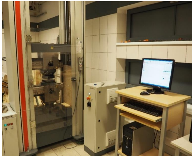
Rys. 59. Stanowisko badawcze do jednoosiowej próby ściskania
