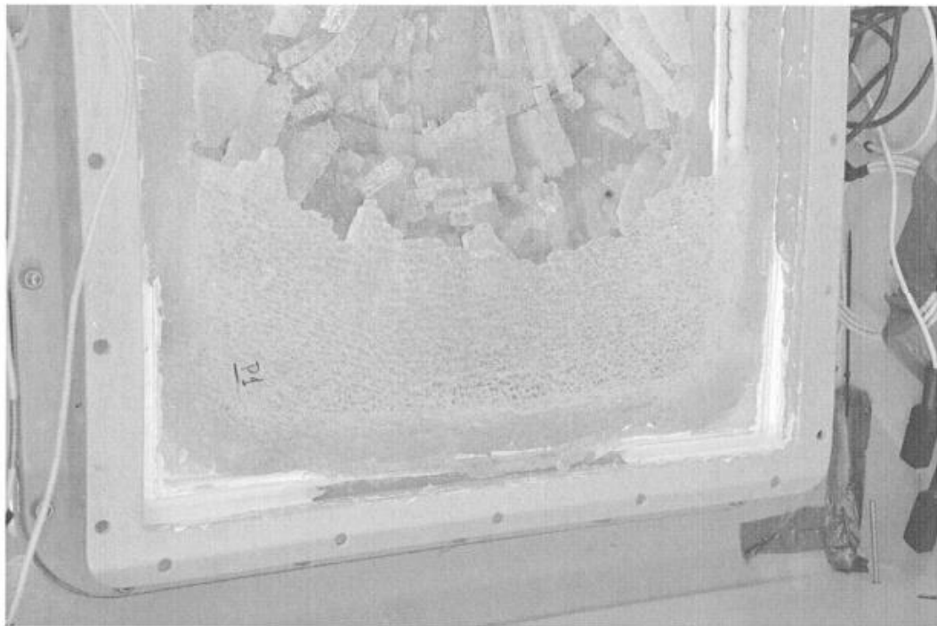
Rys. 135. Fotografia zniszczonej próbki prostokątnej - źródło [50]
