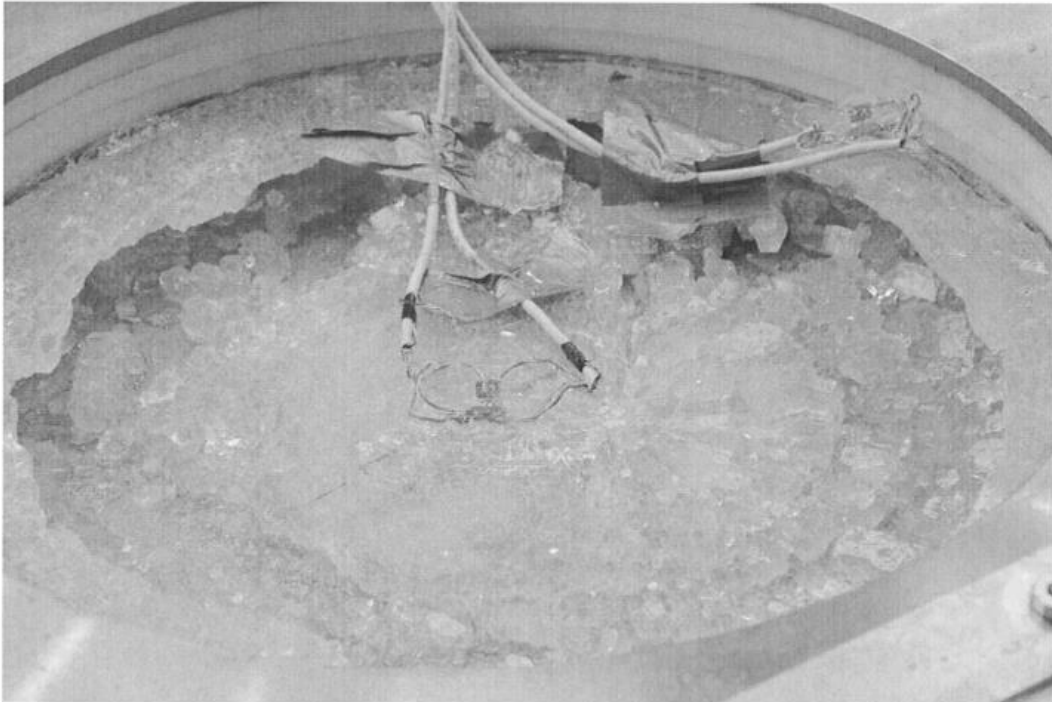
Rys. 133. Fotografia zniszczonej próbki okrągłej - źródło [50]
