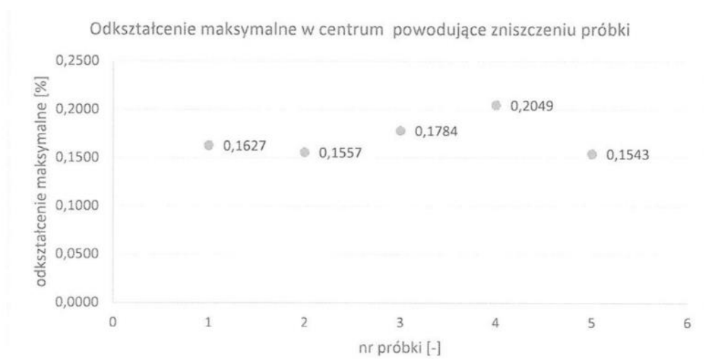
Rys. 130. Wykres odkształcenia maksymalnego powodującego zniszczenie próbki okrągłej – źródło [50]
