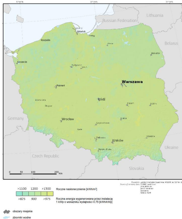
Rys. 2.3.1.4. Roczne nasłonecznienie oraz możliwy uzysk energii słonecznej dla promieniowania słonecznego padającego na a) płaszczyznę horyzontalną, b) płaszczyznę ustawioną pod kątem optymalnym (na podstawie: [24])
