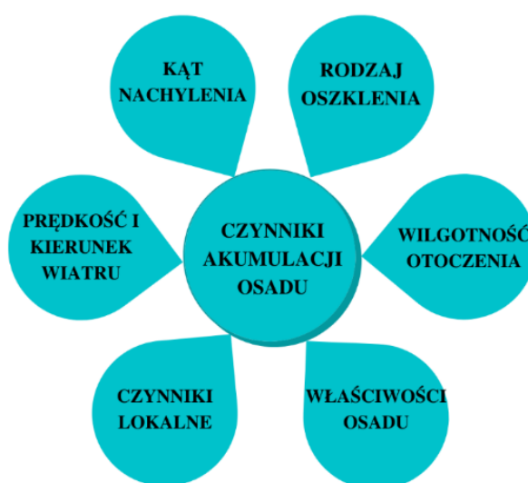
Rys. 3.1. Czynniki determinujące osadzanie się kurzu (opracowanie własne)
