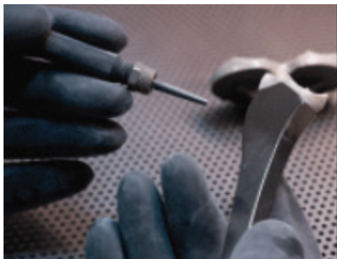
Rys. 2. Przykład obróbki ręcznej w postaci oczyszczania końcowego wydruku
