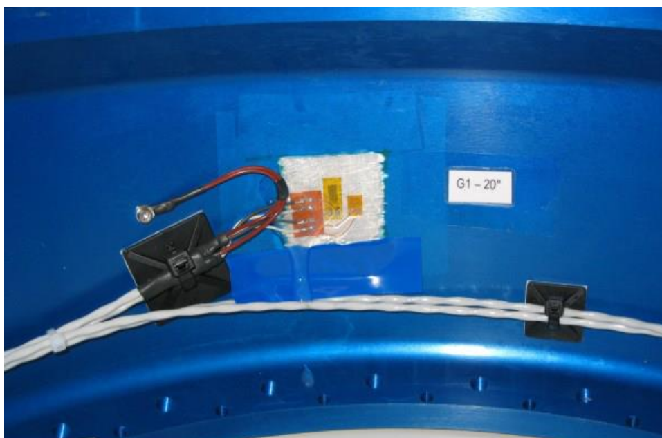
Rysunek 6. Przykład zastosowania tensometru w rakiecie sondującej [55].
