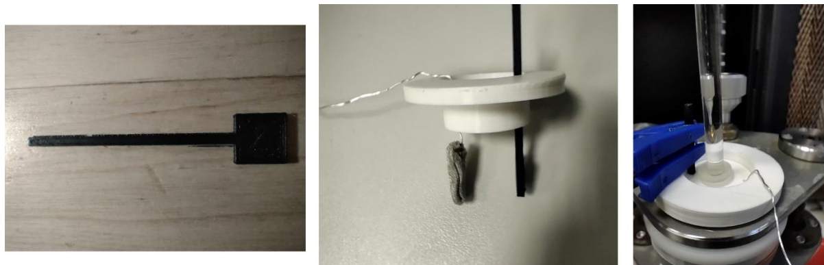
Rysunek 30. Elektroda wydrukowana z PP po pięciokrotnym przetworzeniu z wprowadzonym kontaktem elektrycznym oraz wieczko celki pomiarowej do mocowania elektrod, zaprojektowane oraz wydrukowane 3D.
