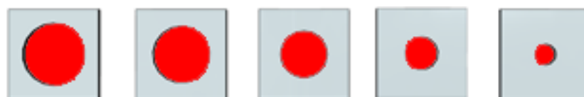
Rysunek 26. Maski wydrukowane 3D z PLA mające na celu odstonięcie powierzchni elektrod CB-PLA, które zostały poddane ablacji Nd:YAG. Grubość masek wynosiła 2 mm [126].
