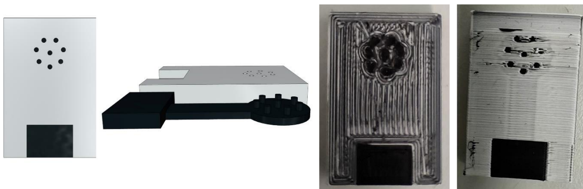
Rysunek 50. Projekt oraz wydruki w orientacji poziomej i pionowej ośmiu punktów o średnicy 1 mm każdy, mających odpowiadać macierzy mikroelektrod.
