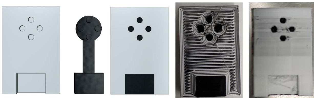
Rysunek 51. Projekt oraz wydruki w orientacji poziomej i pionowej czterech niezależnych od siebie obszarów o średnicy 2 mm każdy.
