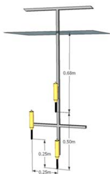
Rys.5. Rysunek poglądowy zestaw hydrofonów odbiorczych
