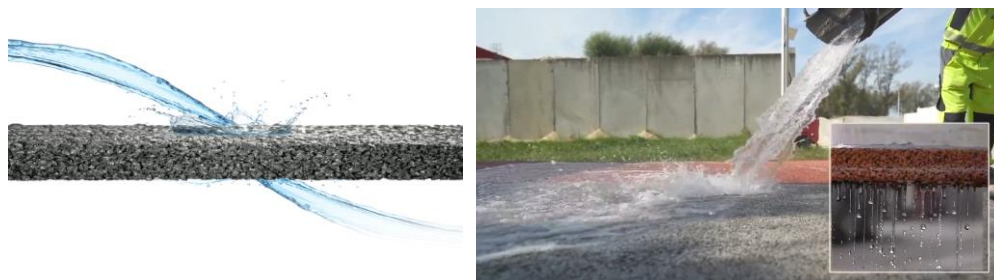
Rysunek 2. Zachowanie betonu PERVIA pod wpływem wody.
