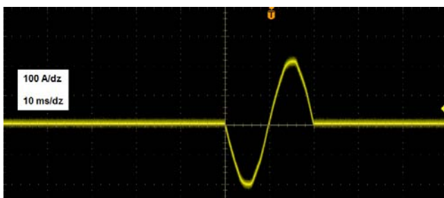
Rys.6. Oscylogram prądu pomiarowego miernika 2. Czas przepływu prądu 20 ms, wartość szczytowa prądu 200 A
