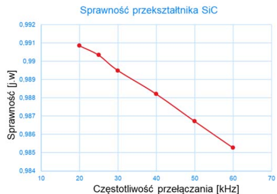
Rys. 4. Charakterystyka sprawności 3-gięziowego falownika SiC w funkcji częstotliwości przełączania tranzystorów przy obciążeniu prądem znamionowym tranzystorów SiC MOSFET równym 30A
