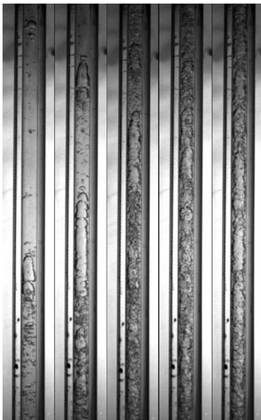
Rysunek 6: Struktury przepływu Pzr=0,6 G=180 \text{ kg}/(\text{m}^2 \cdot \text{s}) stopnie suchości kolejno: 37,2%, 48,6%, 64,6%, 72,8%, 93%
