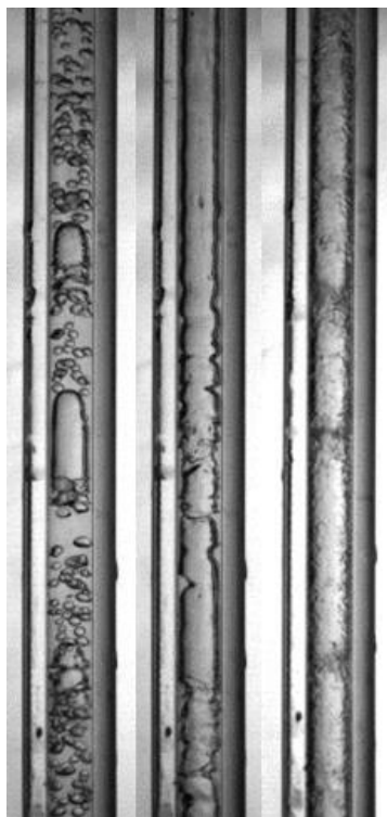
Rysunek 3: Struktury przepływu P_{zr}=0,2 G=355 \text{ kg}/(\text{m}^2\cdot\text{s}) stopnie suchości kolejno: 2%, 7%, 5,03%
