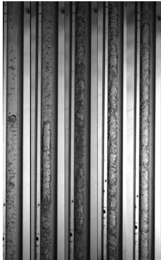
Rysunek 7: Struktury przepływu Pzr=0,6 G=265 \text{ kg}/(\text{m}^2 \cdot \text{s}) stopnie suchości kolejno: 19,6%, 27%, 35,2%, 55,6%
