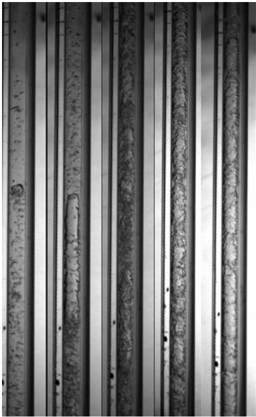
Rysunek 5: Struktury przepływu Pzr=0,6 G=355 \text{ kg}/(\text{m}^2 \cdot \text{s}) stopnie suchości kolejno: 12%, 15,6%, 19,6%, 23,9%, 36,2%, 60,7%
