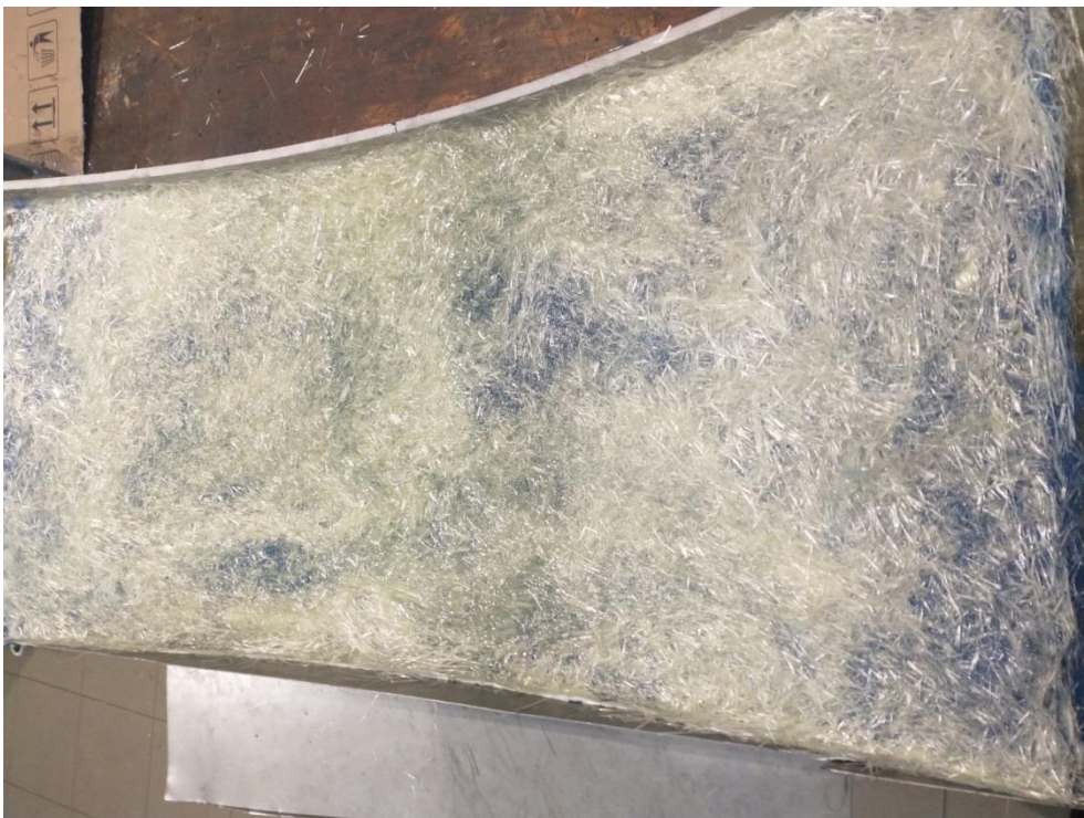
Rys. 79 Forma zewnętrzna pokryta matą szklaną.
