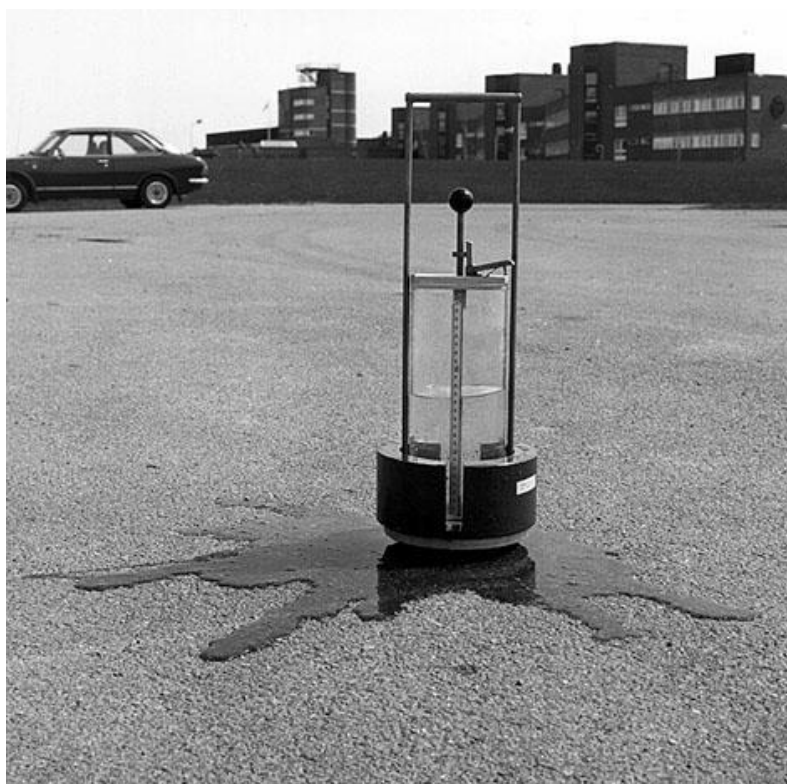
Rys. 15 Pomiar tekstury nawierzchni metodą wypływu cieczy [46].
