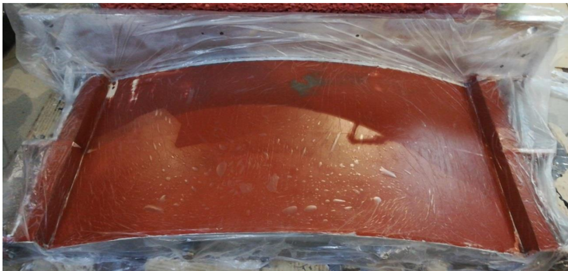
Rys. 80 Forma wewnętrzna pokryta folią.
