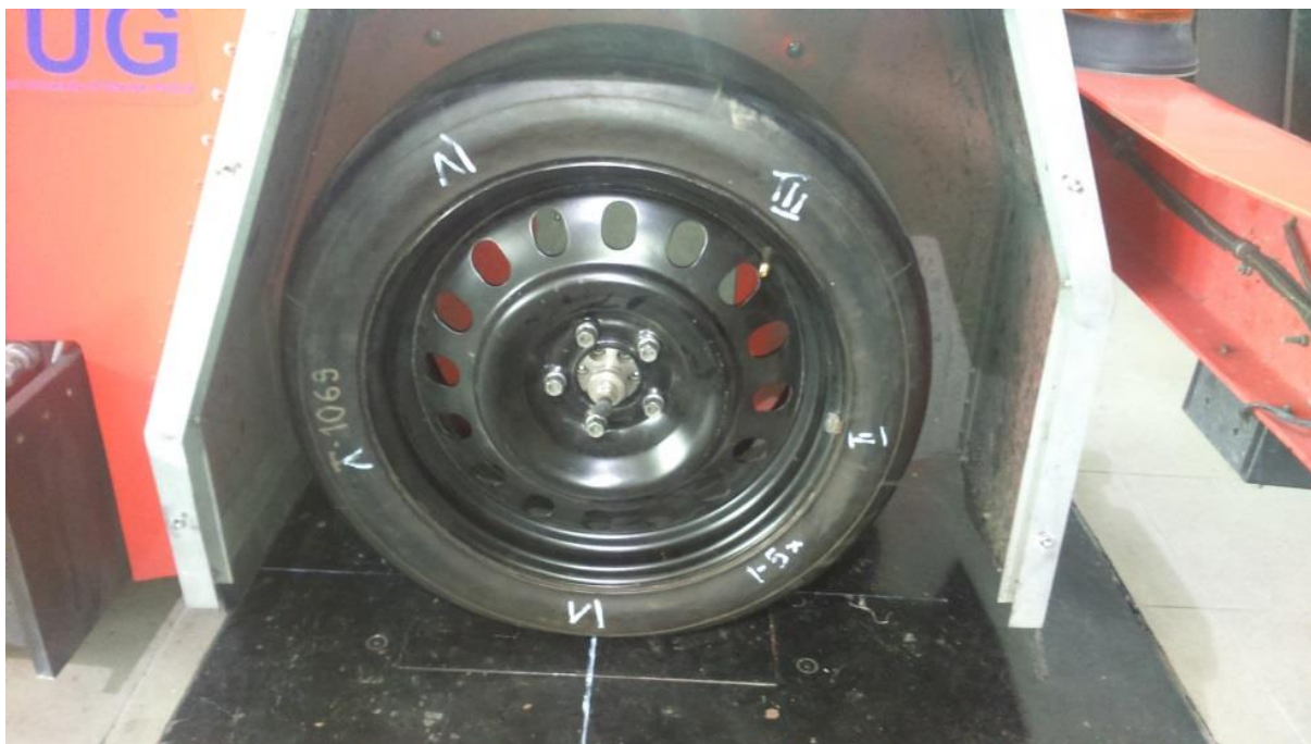
Rys. 23 Koło badane umieszczone na płycie stanowiska pomiarowego.
