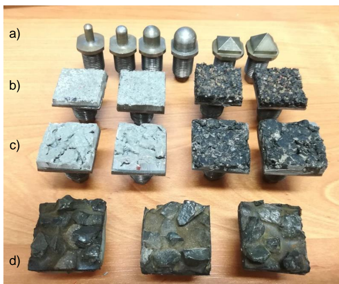
Rys. 30 Penetratory o regularnych kształtach oraz z fragmentami rzeczywistych nawierzchni: a) penetratory o kształcie wypukłej sfery o średnicy: od lewej 6, 8, 12 i 16 mm, następnie penetratory o kształcie wypukłego ostrosłupa o podstawie kwadratu 16 x 16 mm i wysokościach: 4 i 9 mm, b) penetratory z fragmentem nawierzchni PERS o tej samej teksturze, ale różnej sztywności; 2 pierwsze z lewej- sztywna replika nawierzchni poroelastycznej, 2 kolejne- fragment rzeczywistej, poroelastycznej nawierzchni, c) penetratory z fragmentem rzeczywistej nawierzchni: 2 pierwsze z lewej- replika SMA8, 2 następnie- SMA11, d) penetratory z fragmentem rzeczywistej nawierzchni APS4.
