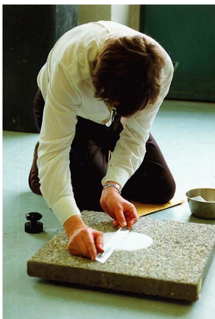
Rys. 14 Pomiar tekstury nawierzchni metodą objętościową [46].
