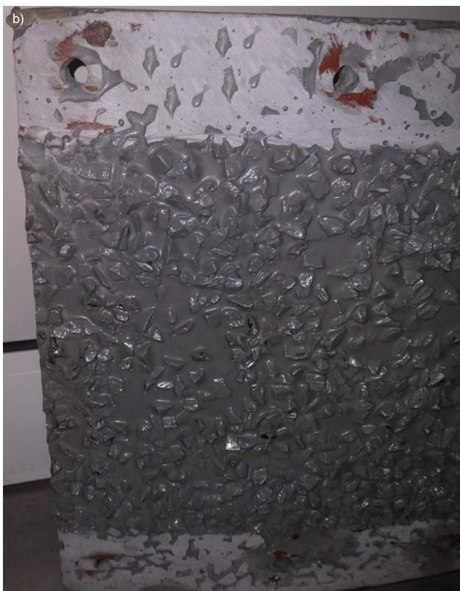
Rys. 85 Segment nawierzchni (replika APS4) poddany obróbce mechanicznej: a) segment nawierzchni z przymiarem do wykonania otworów montażowych , b) ostatni etap przygotowania segmentu nawierzchni do montażu.
