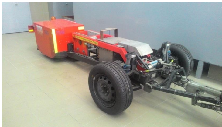
Rys. 6 Przyczepa R 2 Mk.2. do badania oporu toczenia opon samochodowych.
