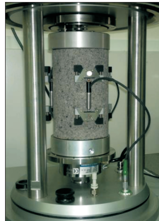
Fig. 8. Specimen prepared for dynamic modulus testing Rys. 8. Widok próbki przygotowanej do badania modułu dynamicznego
