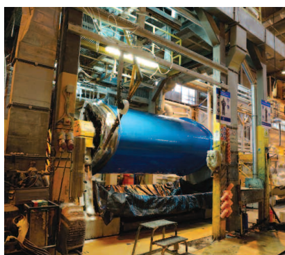
Fot. 1. Technologia produkcji profili niekołowych z tworzywa GRP [1]
