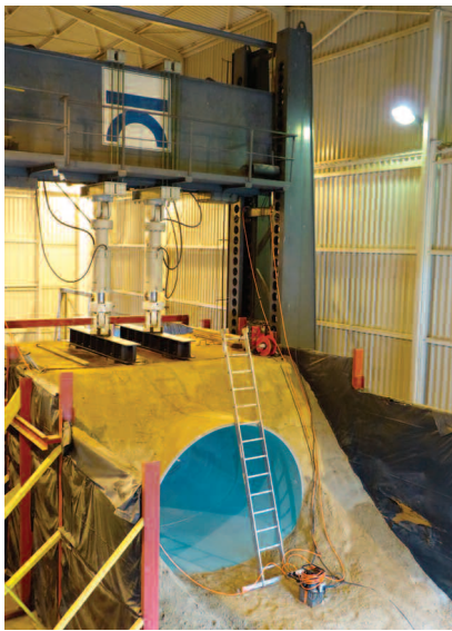
Fot. 3 Zabudowany model z konstrukcją przekazującą obciążenia
