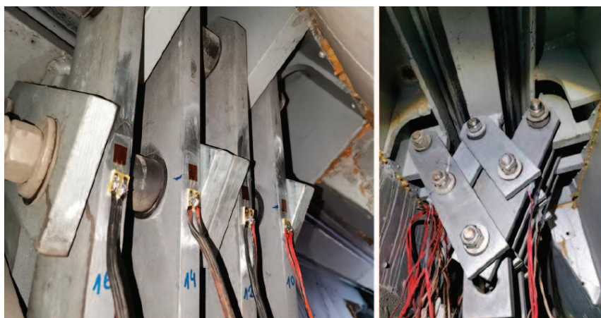
Fot. 1. Tensometry zamontowane na urządzeniu nożycowym [11] Photo 1. Strain gauges installed on a scissor device [11]
