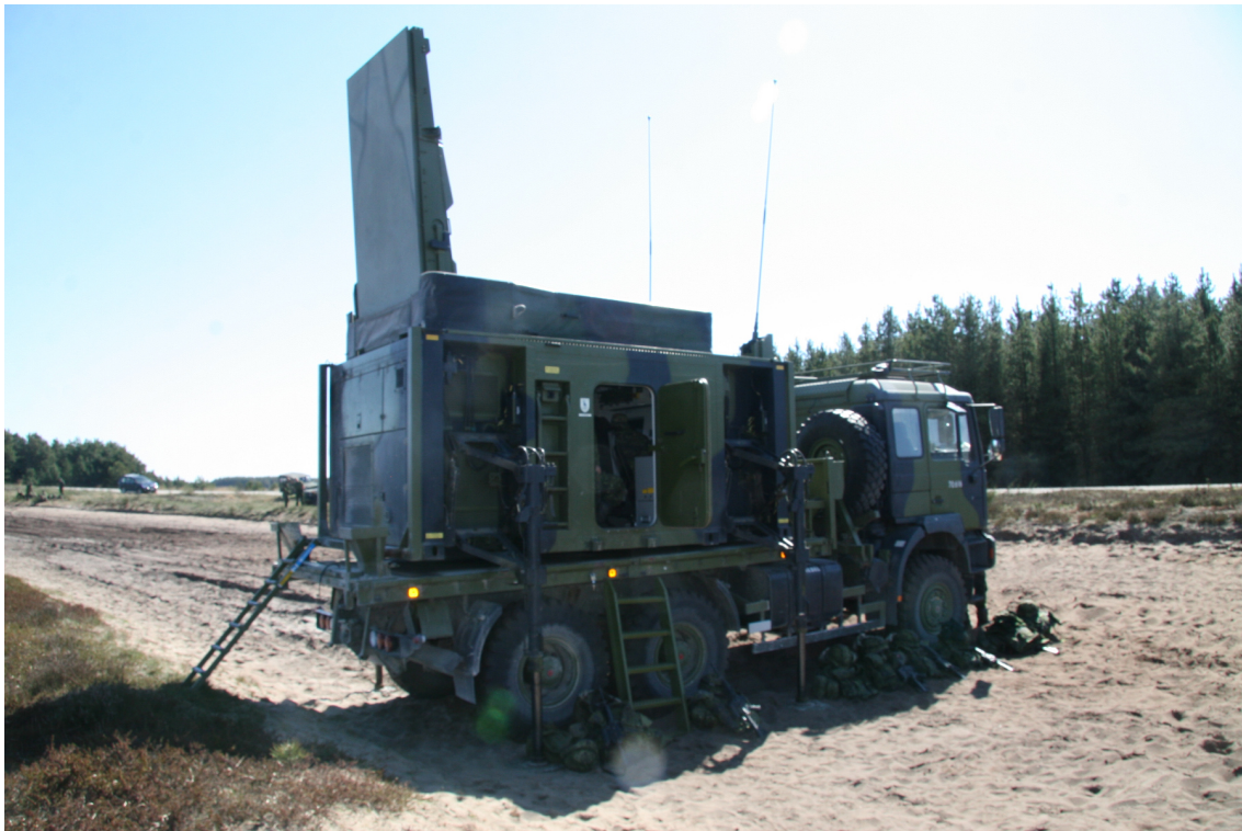
Rys. 3.1: Radar Arthur WRL z anteną wyraźnie dłuższą w osi pionowej.
