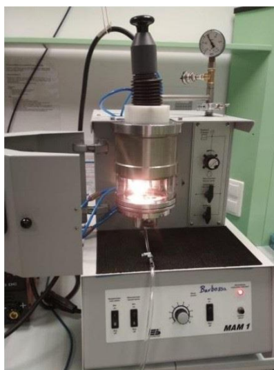
Rys. 23 Piec łukowy MAM-1 firmy GmbH Edmund Buhler
