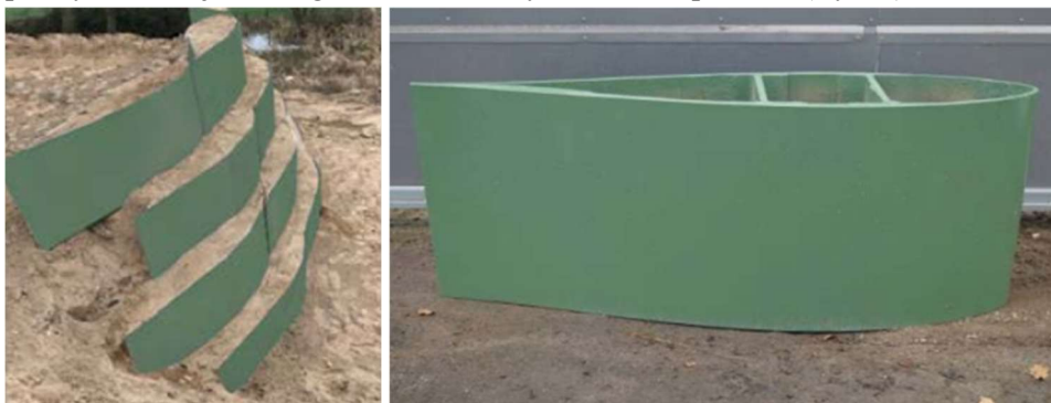
Rys. 7. Bloki geotechniczne wykonane ze zużytych łopat turbin wiatrowych [17]
