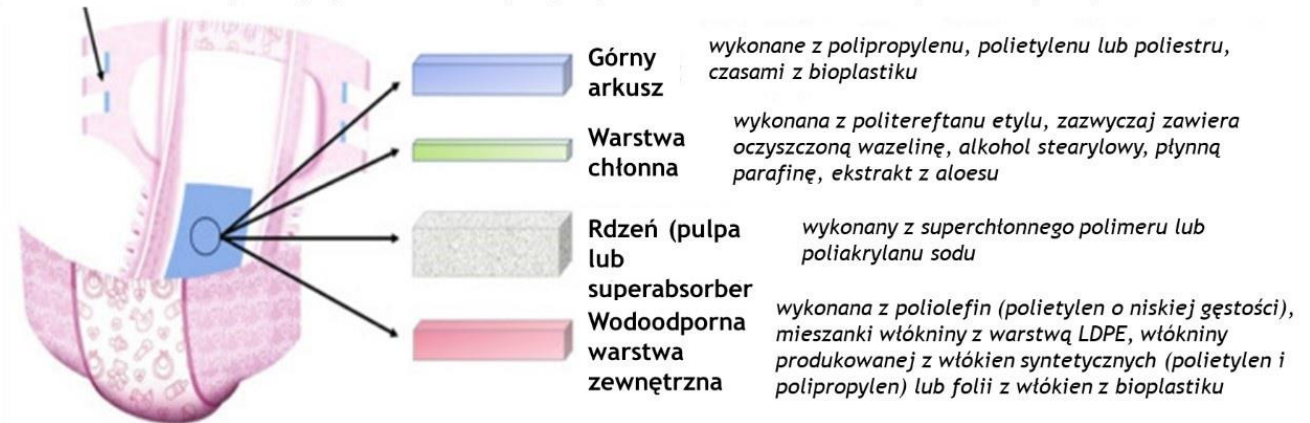
Rysunek 1. Schemat budowy jednorazowej pieluchy dziecięcej
