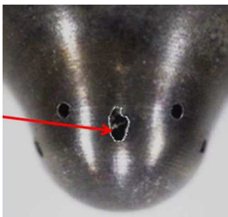
Rys. 1.4. Zużyty rozpylacz paliwa silnika okrętowego wskutek destrukcyjnego oddziaływania miazgi katalitycznej (ang. cat fines ) [Aabo i in., 2005]
