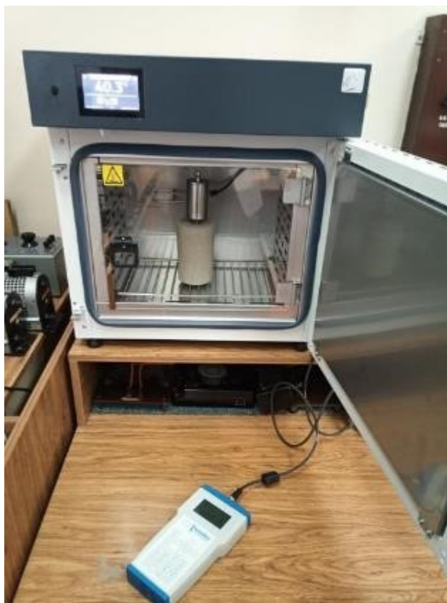
Rysunek 26. Stanowisko badawcze. Miernik rezystywności cieplnej Hukseflux CRU02 połączony z sondą TP07. Wewnątrz cieplarki znajduje się próbka betonitu
