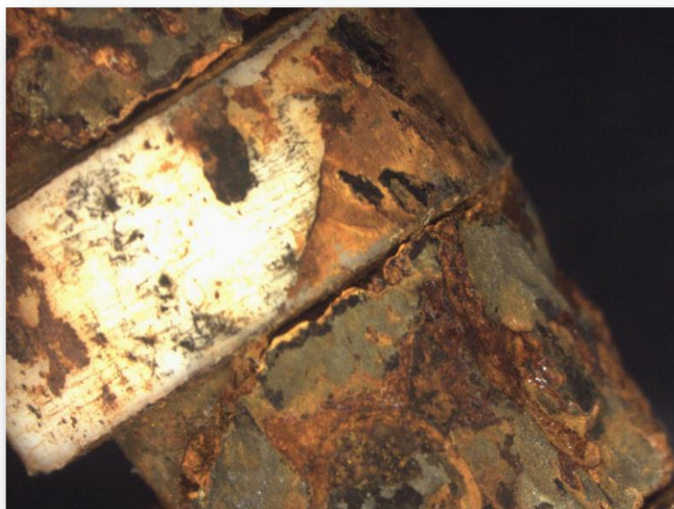
Rysunek 51. Stan czujnika przed wieżą odtleniającą.
