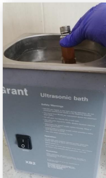
Rysunek 21. Sposób przenoszenia osadu z powierzchni osadu do roztworu.
