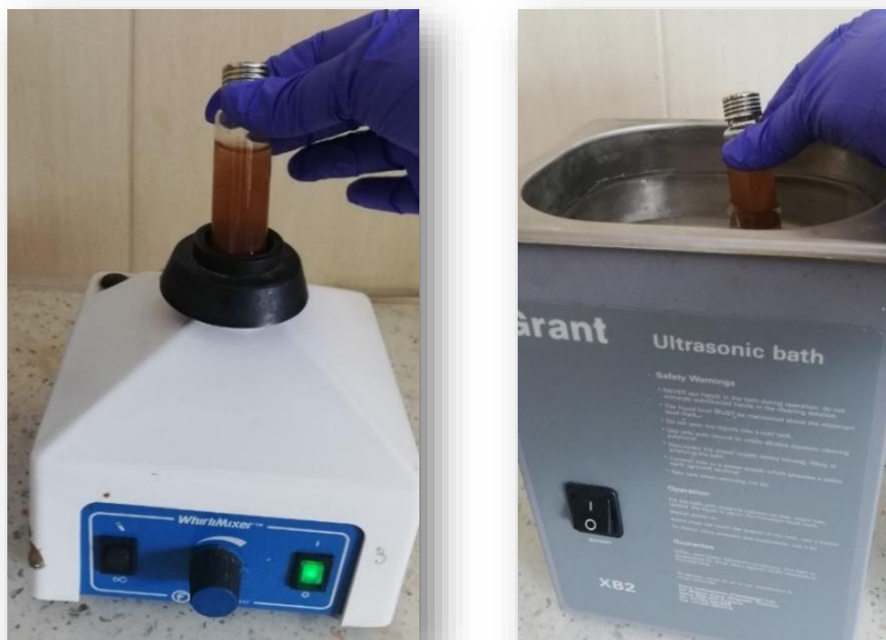
Rysunek 21. Sposób przenoszenia osadu z powierzchni osadu do roztworu.
