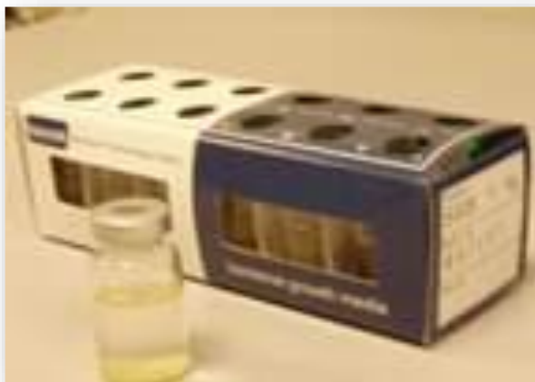
Rysunek 18. Testy na obecność bakterii SRB, pożywka Postgate z solami żelaza.
