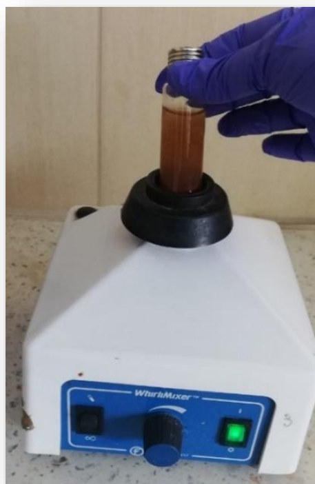
Rysunek 21. Sposób przenoszenia osadu z powierzchni osadu do roztworu.
