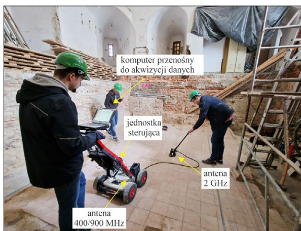
Ryc. 6. Sprzęt georadarowy wykorzystany do badań, 2022; fot. M. Zielińska
