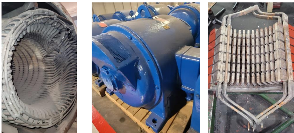
Rys. 2. Silnik 6 kV typu SCDdm114s wybrany do analizy i przygotowania badanego modelu: widok uszkodzenia (a); widok ogólny (b); wycięty fragment stojana z pozostawionymi oryginalnymi cewkami (c)
