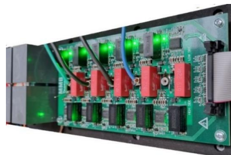
Rys. 2. Widok płyty sterowników bramkowych trójfazowego, 4-gałęziowego falownika SiC realizującego funkcję aktywnego energoelektronicznego symetryzatora prądów fazowych linii (widoczna 5-ta gałąź falownika SiC nie używana)
