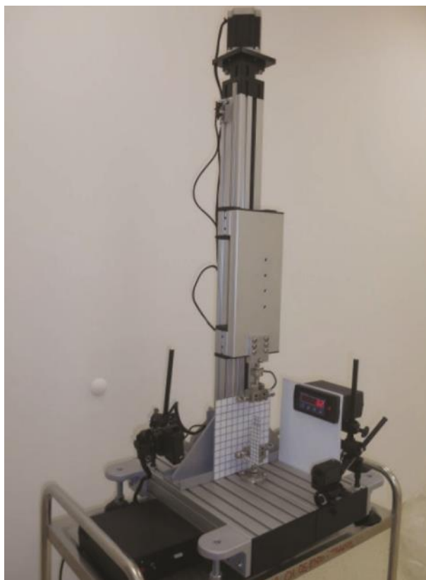
Rys. 10.1. Maszyna do ściskania i rozciągania tkanek [181]
