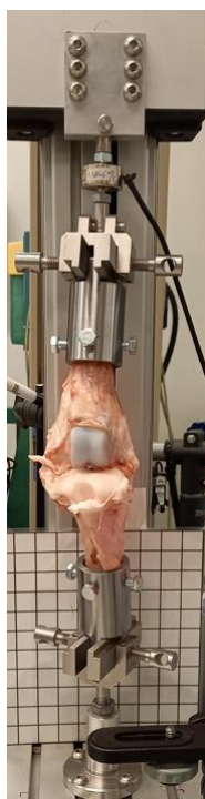
Rys. 10.9. Staw kolanowy zamocowany w stanowisku badawczym
