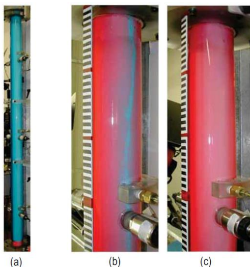
Rysunek 29 Efekt rotacji wewnętrznej rury na proces wypierania a) przed rozpoczęciem tłoczenia cieczy wypierającej, b) wypieranie bez włączenia obrotów wewnętrznej kolumny rur, c) wypieranie z obrotem wewnętrznej kolumny rur [28]
