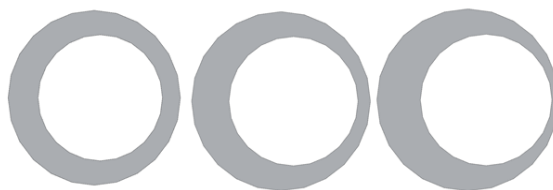
Rysunek 43 Wizualizacja przekrojów poprzecznych przestrzeni pierścieniowych o ecentryczności odpowiednio od lewej strony 25%, 50% i 75%
