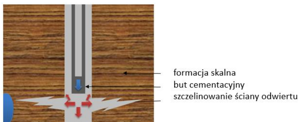
Rysunek 35 Schemat występowania szczelinowania tłokowego w wyniku ruchu kolumny rur
