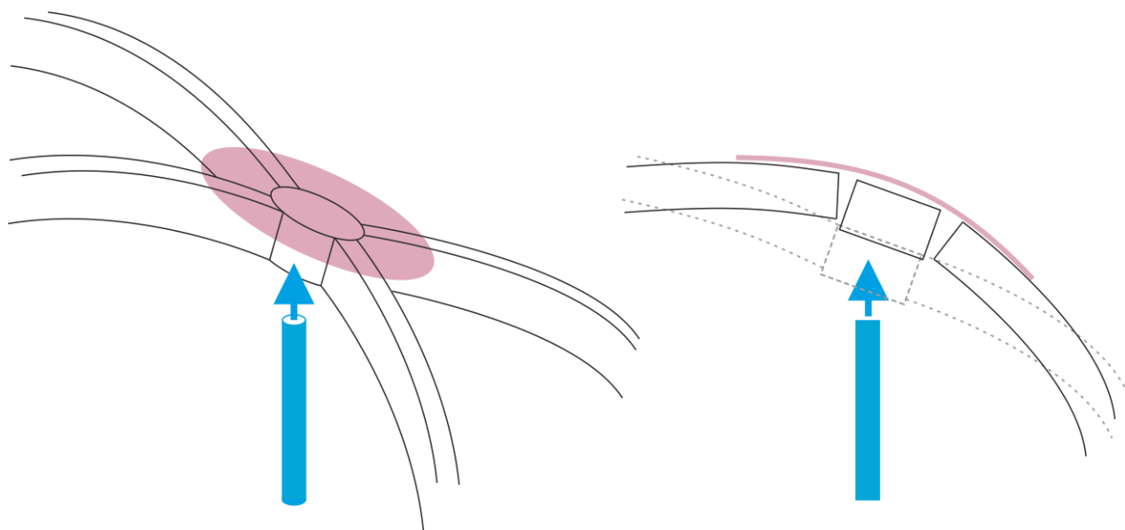
Rys. 75 Schemat węzła pręt tensegrity – zwornik, w aksonometrii i przekroju, z zaznaczonym proponowanym wzmocnieniem matą kompozytową (Bednarz, 2003).
