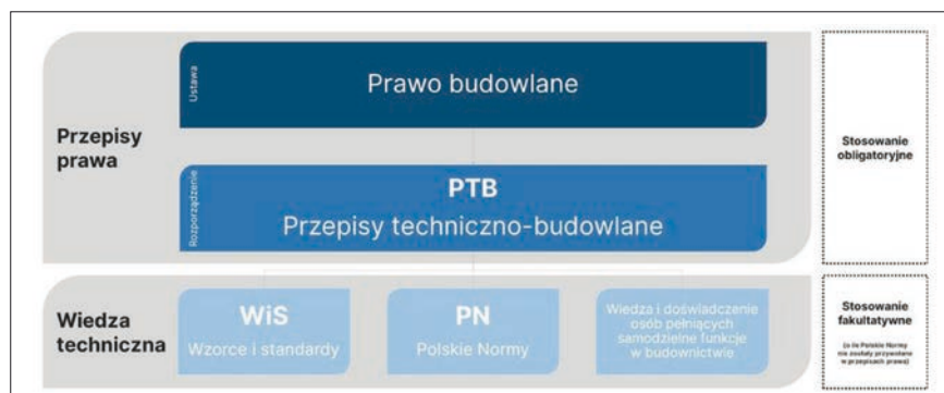
Rys. 1. Schemat zależności pomiędzy składowymi wymaganiami technicznymi w budownictwie [10]
