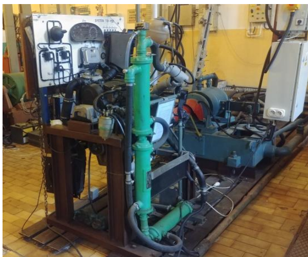
Rys. 5.1. Zdjęcie stanowiska badawczego wyposażonego w silnik AJM 1.9 TDI
