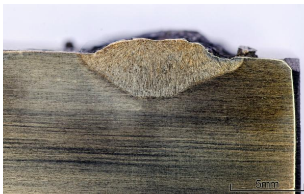
Rys. 61. Przekrój poprzeczny napoiny BW1-1, q_l=0,82 kJ/mm, DC (-)
