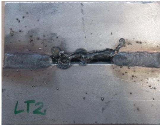
Rys. 104. Widok spoin próbnych w próbce 1TBM wykonanej elektrodami Böhler (a), oraz próbki LTM wykonanej elektrodami Lincoln Electric (b) w sztucznej wodzie morskiej
