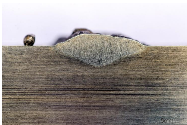
Rys. 64. Przekrój poprzeczny napoiny BWN3-2, q_l=0,93 kJ/mm, DC (-)
