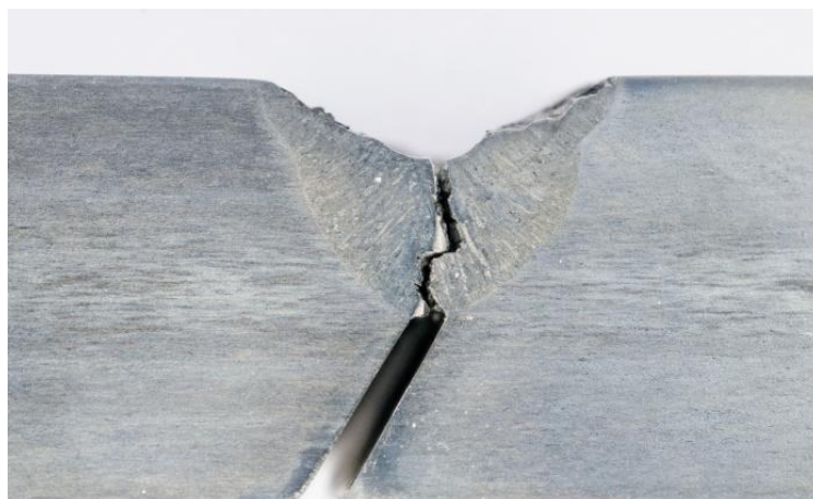
Rys. 109. Próbką Tekken 1TBM-2 Przekrój spoiny próbnej wykonanej w wodzie morskiej elektrodami BÖHLER. Pęknięcie w metalu spoiny inicjujące od strony grani
