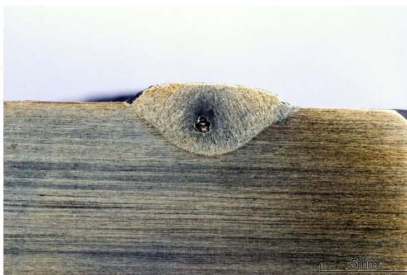
Rys. 69. Przekrój poprzeczny napoiny BWN9-1, q_l=0,90 kJ/mm, DC(-)
