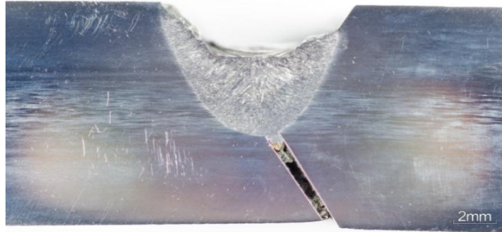
Rys. 106. Próбка Tekken 1TBS-1 - przekrój spoiny próbnej wykonanej w wodzie wodociągowej elektrodami BÖHLER. Brak pęknięć
