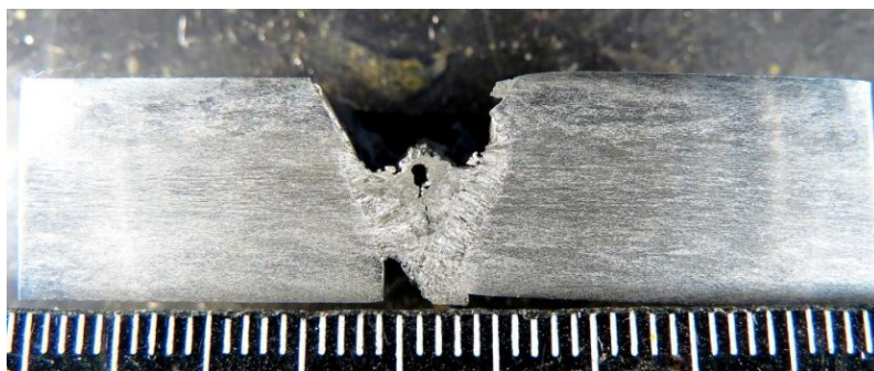
Rys.122. Przekrój złącza próbnego 1ZBS1 wykonanego w wodzie wodociągowej elektrodami BÖHLER. Widoczne pęknięcie w osi spoiny oraz inne niezgodności: jama skurczowa (201), niepełny przetop w grani (4021), niewłaściwy kształt spoiny (500), nieregularna powierzchnia (514)
