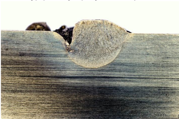
Rys. 67. Przekrój poprzeczny napoiny BWN2-2, q_l=0,93 kJ/mm, DC (-)
