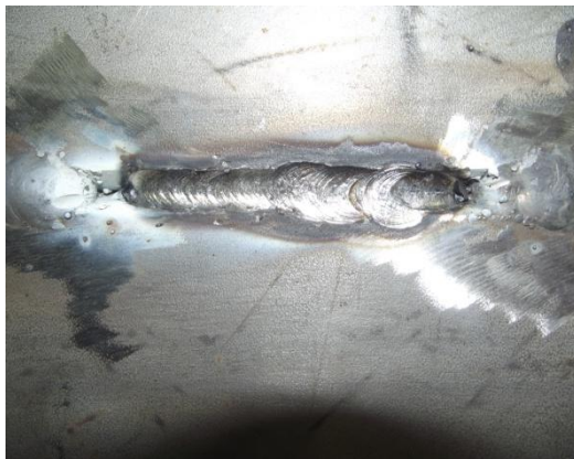
Rys. 104. Widok spoin próbnych w próbce 1TBM wykonanej elektrodami Böhler (a), oraz próbki LTM wykonanej elektrodami Lincoln Electric (b) w sztucznej wodzie morskiej
