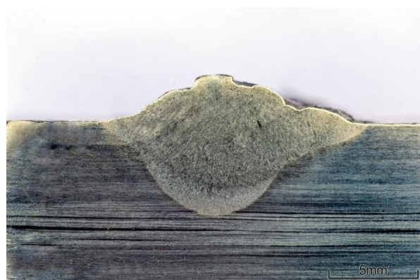
Rys. 67. Przekrój poprzeczny napoiny BWN2-2, q_l=0,93 kJ/mm, DC (-)
