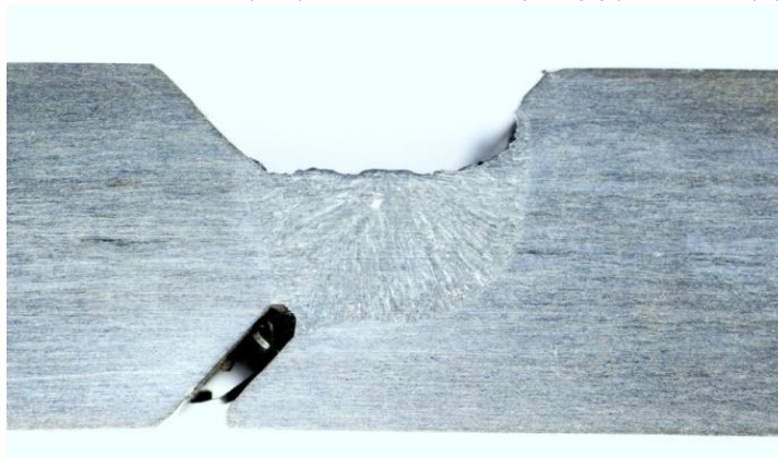
Rys. 108. Próbką Tekken 2TBM - przekrój spoiny próbnej wykonanej w wodzie morskiej elektrodami BÖHLER. Brak pęknięć
